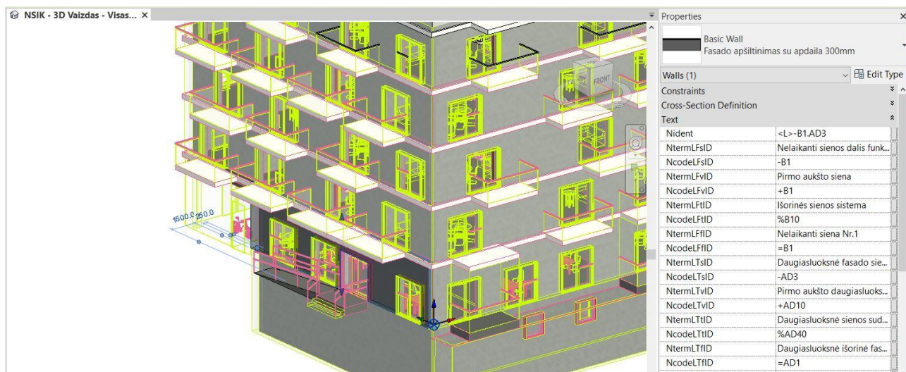
30 pav. Techninės sistemos objekto identifikavimas taikant BIM su autorine PĮ
