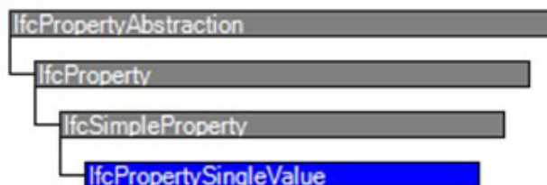
25 pav. Dinaminėms IFC savybėms skirtos informacinės klasės IFC4 metamodelyje
